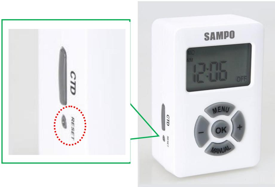
請重複按壓“MANUAL”按鈕直到面板出現“ON”字樣，如下圖中間圖示，此時本充電車之風扇、各部位的電源插座皆處於啟動供電中。本定時器狀態介紹如下：
