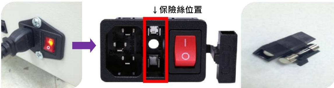
檢查 5 孔電源排插--開啟機櫃後門檢查排插跳脫開關是否在開的位置(開的位置可觸摸到凸點)。
